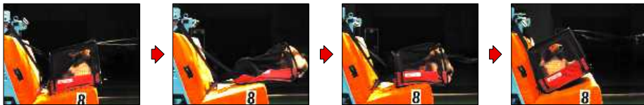
50km/hの衝突実験で安全性は実証済み（8kg犬のぬいぐるみによる実験：実験機関「JARI」（日本自動車研究所）
